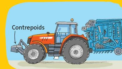
On installe aussi un contrepoids à l'avant d'un **tracteur** s'il doit porter des machines très lourdes à l'arrière.
