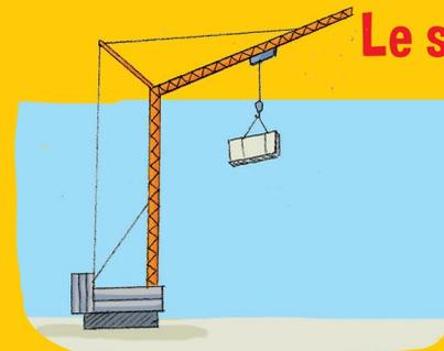
Parfois, le contrepoids est installé **en bas** de la grue. Il tire alors sur le haut de la grue grâce à des tiges de fer.
